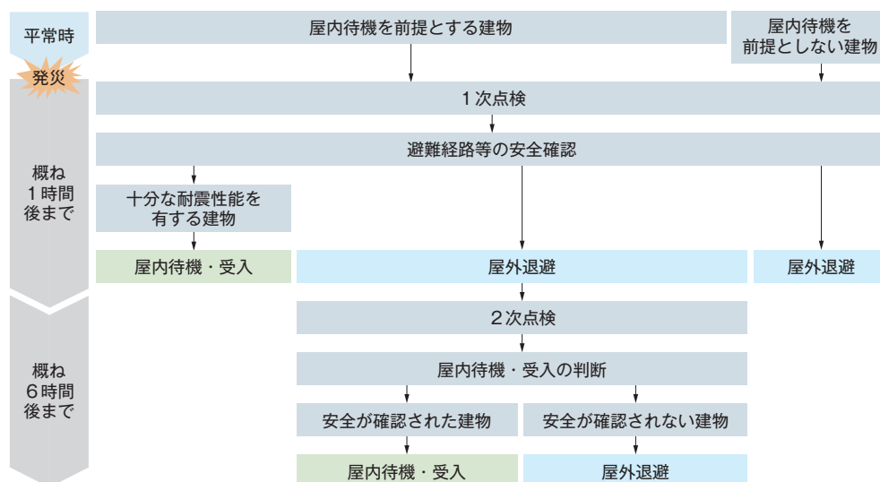
図2 ■ 建物点検フロー例 12)
